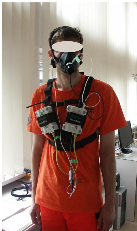
Ryc.41. Pomiar wydatku energetycznego przy pomocy aparatu Oxycon mobile firmy Jaeger (fotografia własna).
