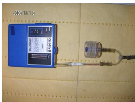
Rysunek 2. Próbnik adsorpcyjno-filtracyjny do pobierania WWA
