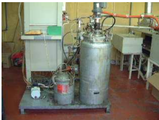
Rysunek 11. Stanowisko montażu odgromników – dozownik żywicy.
