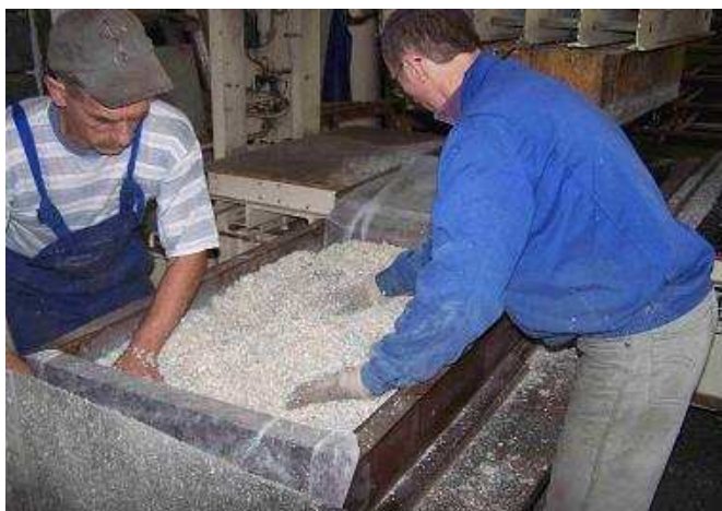
Rysunek 15. Proces wstępnego formowania płyt w formach i na blachach obiegowych
