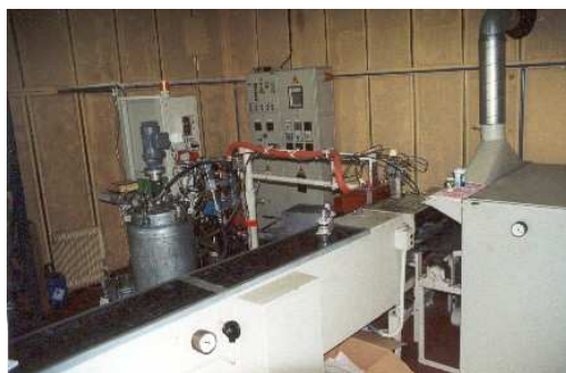
Rysunek 12. Stanowisko montażu odgromników automatyczna linia.
